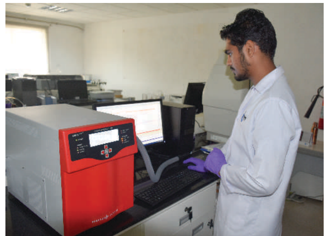
▲ गैस क्रोमेटोग्राफी मास स्पेक्ट्रोमीटर (GC-MS), OmniStar" GSD 320 O1, 1-100 amu
